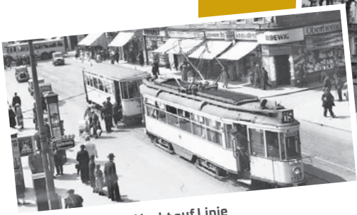
1931: Der Große Hecht auf Linie Markante Neuerungen waren die geschlossene Fahrerkabine mit einem Sitz für den Fahrer sowie die zwei zweiachsigen Drehgestelle.
