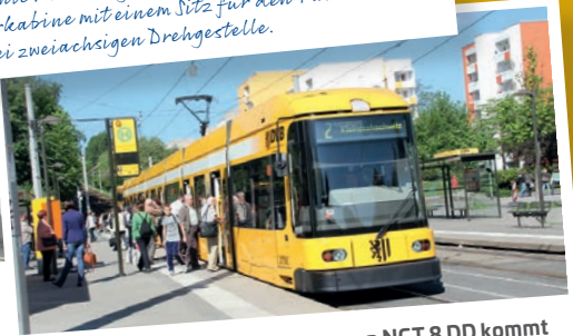
1. Juni 2001: Der Niederflurwagen NGT 8 DD kommt Ersetzt mit der richtigen Platzkapazität die Doppeltraktion der NGT 6 DD auf stark genutzten Linien.
