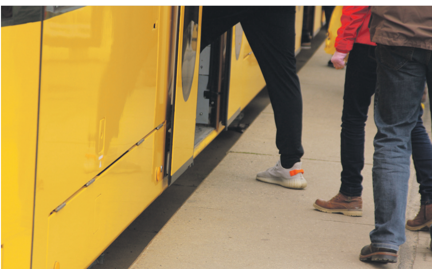
Wegen des Niveauunterschiedes am Bahnsteig bisher nicht für Rollstuhlfahrer geeignet: Haltestelle Liststraße wird jetzt zur barrierefreien Station umgebaut. Dann kann ebenerdig zwischen Bussen und Bahnen umgestiegen werden.
