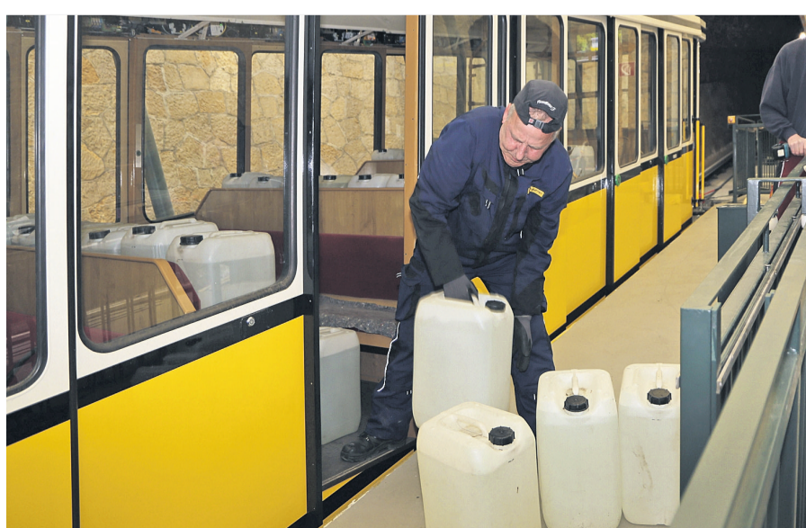
Bevor wieder Passagiere mitfahren dürfen, muss sich das technische Denkmal noch einem Härtebetrieb unterziehen: Michael Reinhold simuliert mit Wasserkanistern einen mehr als voll besetzten Wagen.
